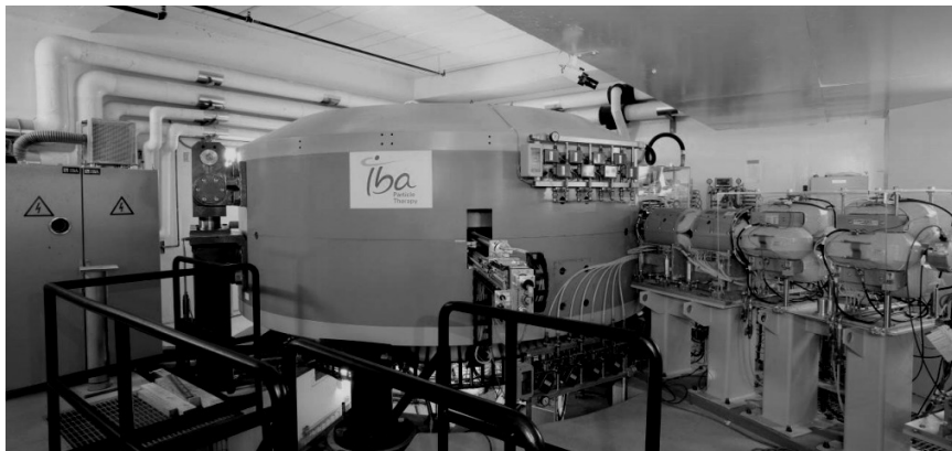
Рис. 3.6.3. Протонный изохронный циклотрон медицинского назначения C230 от компании IBA с «горячими» магнитами. Энергия ускоренных частиц 230 МэВ, диаметр магнита 4,3 м, максимальная величина магнитного поля 2,2 Тл [15].
