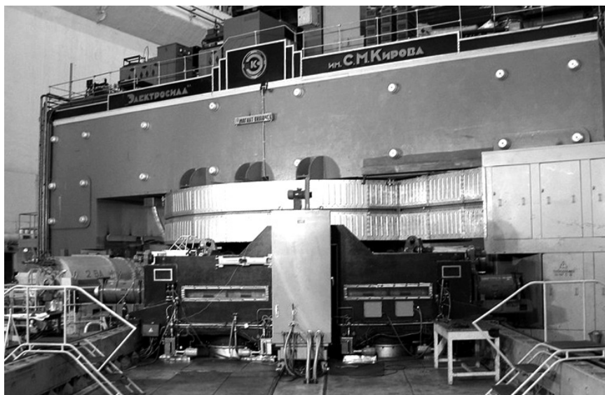
Рис. 3.5.1. Фазотрон ОИЯИ, г. Дубна. Максимальная энергия для протонов составляет 660 МэВ, частота модуляции — 250 Гц, ток пучка — от 1,6 до 2,5 мкА в зависимости от режима вывода. Установка используется для экспериментов с \pi -мезонами, мюонами, нейтронами и протонами, в частности, для медицинских исследований в области лечения онкологических заболеваний [14].
