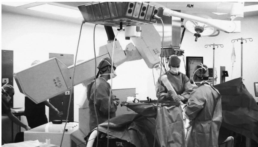
Рис. 4.2.2. Процесс интраоперационной терапии с помощью ускорителя NOVAC11. Максимальная энергия электронов 10 МэВ, ток пучка около 1,5 мА.
