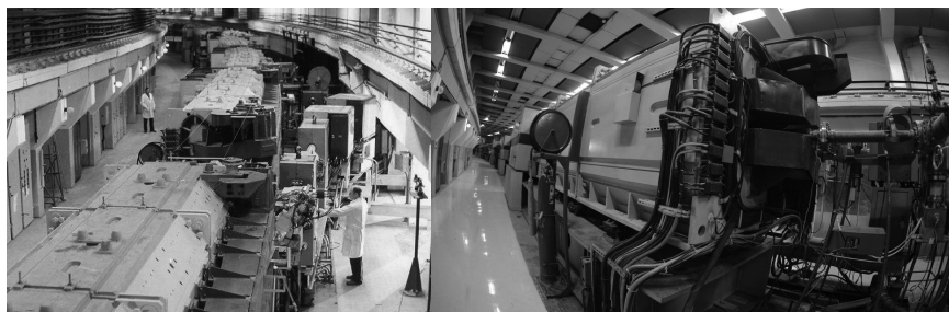
Рис. 3.8.2. Протонный синхротрон У-70, ИФВЭ НИЦ «Курчатовский институт», г. Протвино. Длина орбиты 1,5 км, частота ускорительных циклов 0,1 Гц, энергия до 70 ГэВ и интенсивность 10^{13} для протонов, энергия до 34 ГэВ/нуклон и интенсивность 3 \cdot 10^9 для легких ядер [19].
