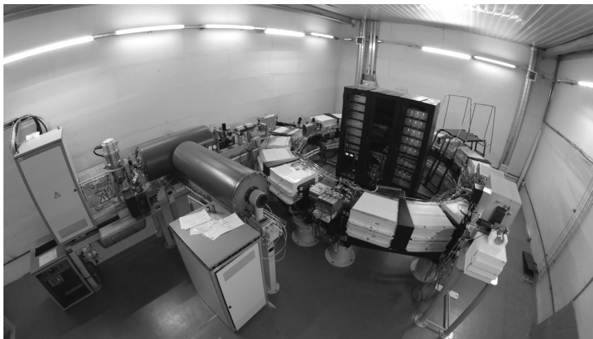
Рис. 3.8.3. Медицинский протонный синхротрон для протонной терапии, ФТЦ ФИАН, г. Протвино. Диапазон выходных энергий 70–330 МэВ, интенсивность порядка 10^9 , диаметр кольца синхротрона 5 м, диаметр пучка на выходе 2–3 мм, время ускорения до энергии 330 МэВ около 1 с [20].
