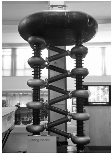
Рис. 3.1.2. Каскадный генератор с выходным напряжением 1,5 МВ, Кавендишская лаборатория, Кембридж.
