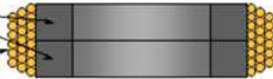
Рис. 2-3-1. Конструкция устройства. Коллекторная обмотка на ферритовом сердечнике.
