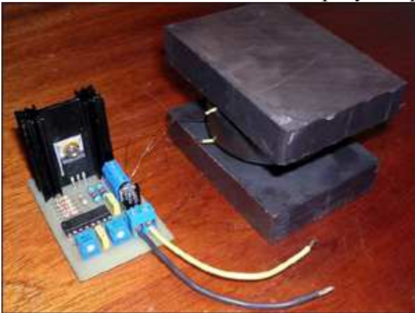
Рис. 2-3-5. ТЭГ в сборе (внешний вид).
