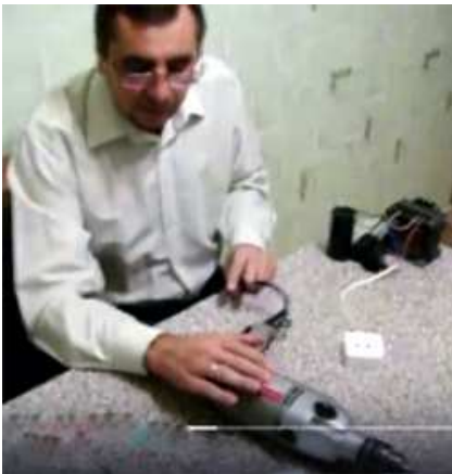
Рис. 3-1-5. Проведение эксперимента, подключение дрели к слабому трансформатору.
