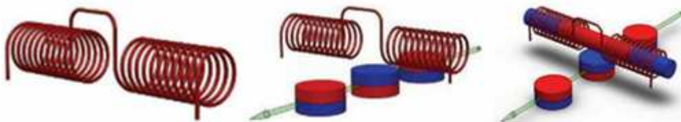
Рис. 3-3-5. Бифилярная катушка в переменном магнитном поле.
