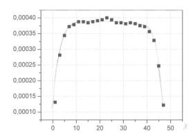
Экспериментальная проверка однородности поля колец Гельмгольца.
